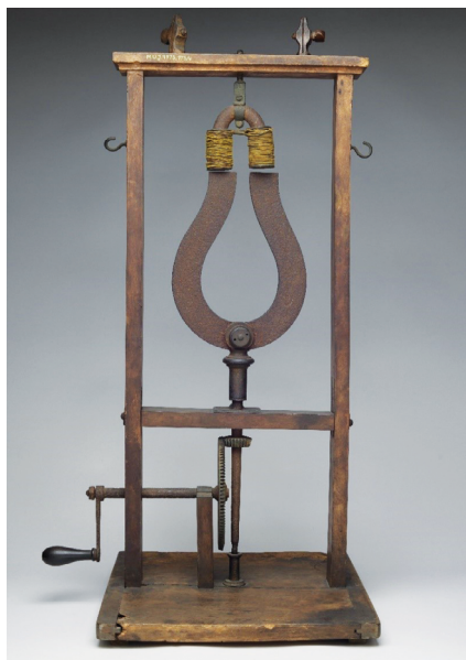
Ryc. 11. Machina elektromagnetyczna, Hippolyte Pixii, ok. 1832, Paryż, własność Muzeum Uniwersytetu Jagiellońskiego, nr in. MUJ-1157-I, fot. Karol Kowalik (za zgodą Muzeum Uniwersytetu Jagiellońskiego)
